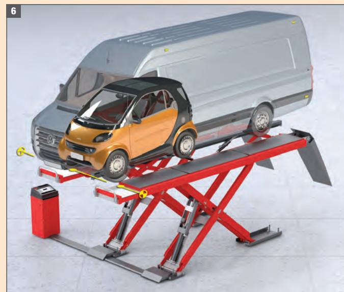
**7.** Sistema di **livellamento idraulico a controllo elettronico**.
