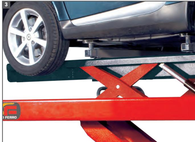
**4.** L'incavo piatti rotanti e le piastre oscillanti sono registrabili per ottenere una **perfetta planarità delle pedane**.
